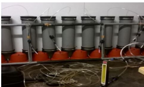
Figuur 2: potproeven in het labo te UGent. Links: de herwonnen meststoffen zitten in polyethyleen potten in buizen waaraan leidingen zijn gekoppeld. Lucht wordt onderaan ingeblazen, om de broeikasgasemissies aan de bovenkant te meten. De vrijgekomen CO_2 , lachgas, ammoniak en methaan worden gedurende enkele uren gemeten via een infraroodgasmonitor (rechts).
